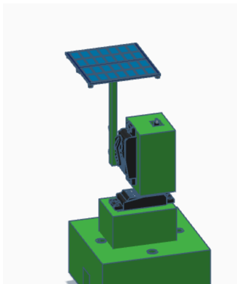
Ilustración 2 – Esta figura muestra el modelo 3D del proyecto Great Solar Tech, desarrollado en Tinkercad. El modelo fue impreso en PLA utilizando una impresora 3D y, posteriormente, se integró el circuito anterior, con un panel solar colocado en la parte superior.
