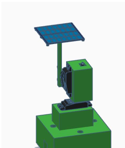
*Ilustración 2 – Esta figura muestra el modelo 3D del proyecto Great Solar Tech, desarrollado en Tinkercad. El modelo fue impreso en PLA utilizando una impresora 3D y, posteriormente, se integró el circuito anterior, con un panel solar colocado en la parte superior.*
