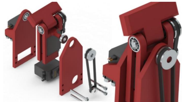
Figura 35: Mecanismo para la muñeca con servomotores de Coogley (2018)
