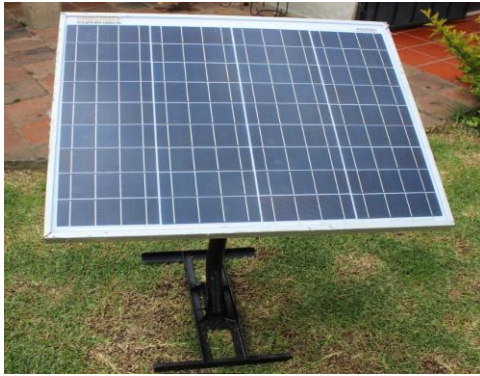
Figura 3. Panel solar fotovoltaico, policristalino utilizado en el sistema de carga.
