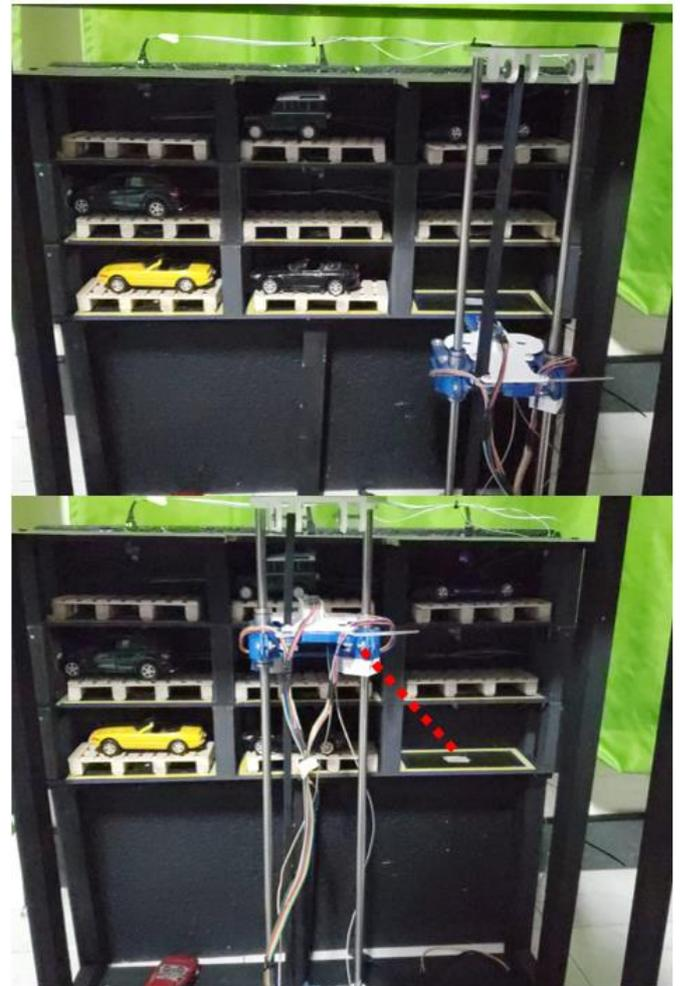
Figura 9. Proceso de interpolación de movimiento del cabezal. Fuente propia.
