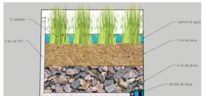
**Figura 2.** Diseño del humedal artificial con sus respectivos componentes los cuales son grava, tierra, bomba de agua pequeña, tubo de PVC, plantas (en los humedales A y B), agua coloreada (humedal A y C), y agua potable (humedal B).
