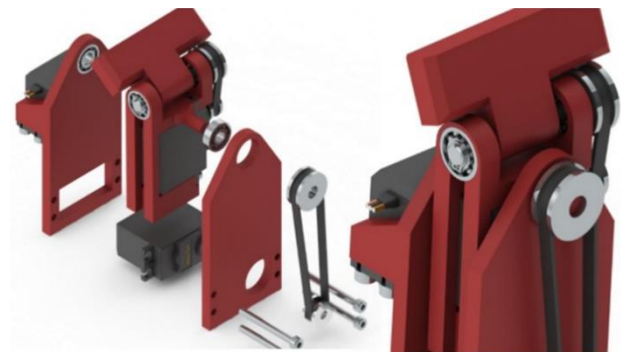
Figura 35: Mecanismo para la muñeca con servomotores de Coogley (2018)
