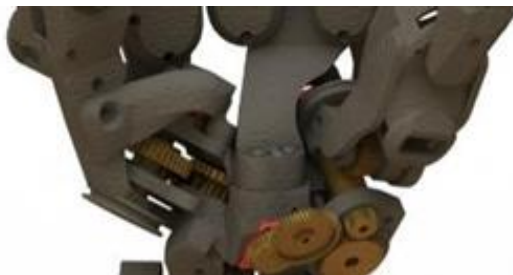
Fig. 42. Vista detallada del mecanismo de engranajes, dedo pulgar
