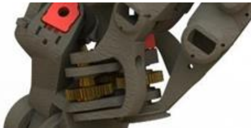
Fig. 41. Vista detallada al mecanismo de engranajes, dedos anular y meñique
