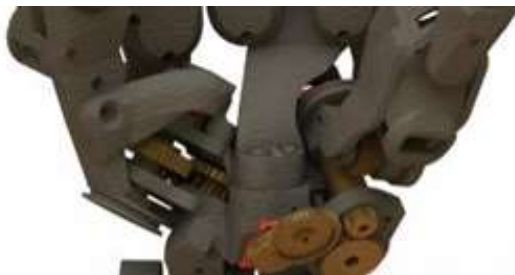
Fig. 42. Vista detallada del mecanismo de engranajes, dedo pulgar
