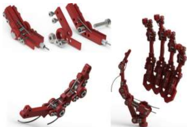
Figura 36: Mecanismo para extensión de falanges, Coogley (2018)
