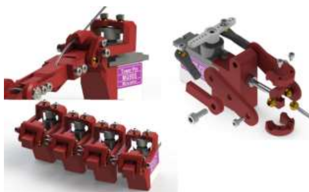
Figura 37: Mecanismo movimiento metacarpianos-falanges Coogley (2018)
